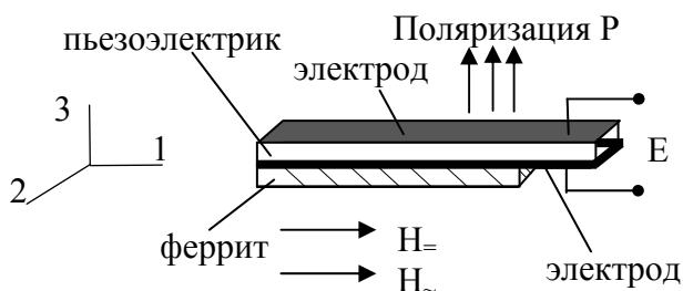
Рис. 1. Схематическое изображение двухслойной структуры.
