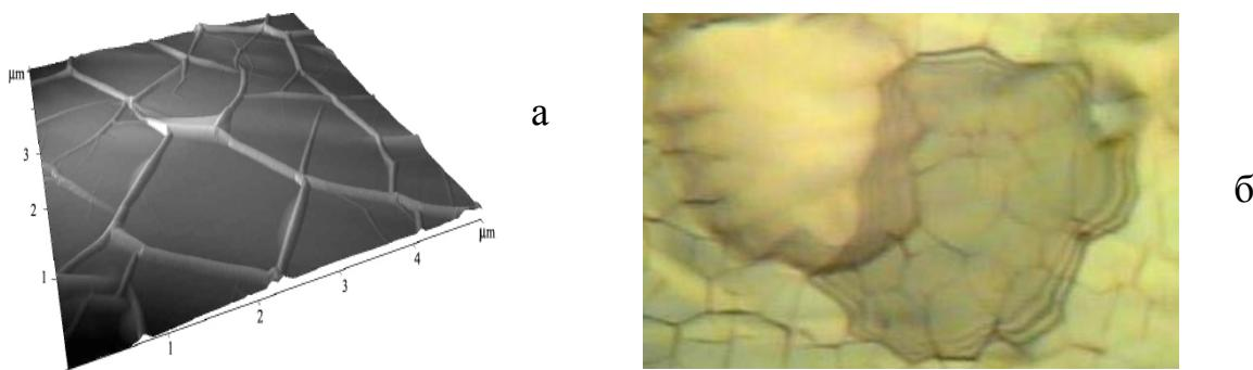
Рис. 1. АСМ изображение тонкой графитной пленки (а); Микрофотография пузырей с тонкими прозрачными и не-прозрачными стенками(б);
