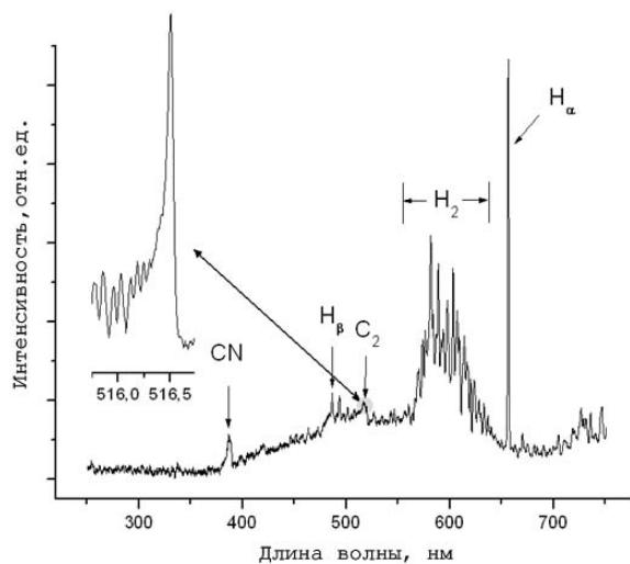
Рис.1. Характерный вид оптического эмиссионного спектра плазмы.
