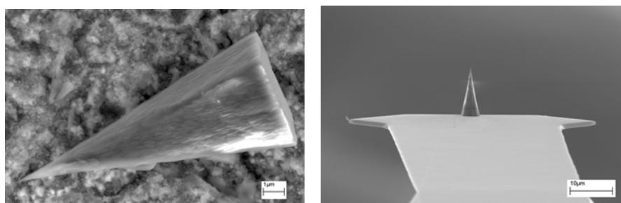
Рис.1 Монокристалл алмаза пирамидальной формы, полученный методом, описанным в работе
