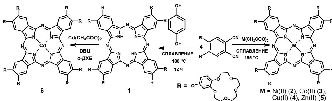
Соединения **1 – 6** выделяли хроматографически на нейтральном  $\text{Al}_2\text{O}_3$  с использованием в качестве элюента смеси хлороформ – метanol. Строение синтезированных соединений подтверждено методами ЭСП, MALDI-TOF масс-спектрометрии, ЯМР  $^1\text{H}$ -спектроскопии для **1, 2, 5, 6** и ЭПР-спектроскопии для **3 и 4**.
