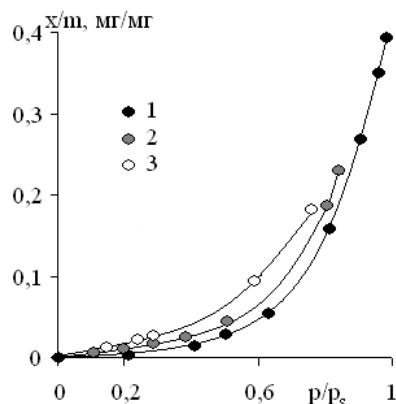
РИС. 1. Изотермы сорбции пленок ПАК при разных температурах: 1 – 25; 2 – 35; 3 – 45 °C.
