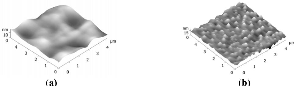
Рис. 1. 3D ACM изображение тонкой пленки дипептида L-аланил-L-валин (а) до и (б) после связывания паров пиридина и последующей осушки пленки в токе теплого воздуха.
