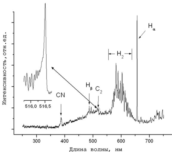
Рис.1. Характерный вид оптического эмиссионного спектра плазмы.
